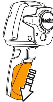
3 - Déverrouiller l'accumulateur et le retirer.
